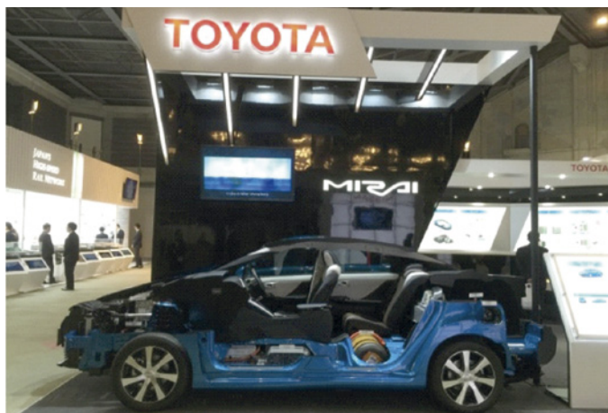
Nejnovější osobní automobil Toyota MIRAI s elektrickým vodíkovým pohonem s palivovými články.
