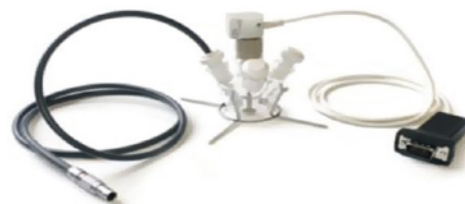
Obr. 3: Reakční nádoba s míchadlem a elektrodami
