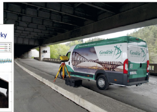
Přístrojové vybavení – pozemní interferometrický radar
