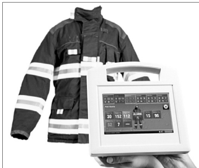
Obr. 1: Chytrý hasičský zásahový oblek s integrovaným mikrosystémem
