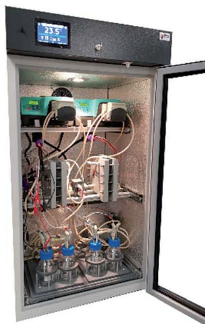
Laboratorní testovací stanice se dvěma články redoxní průtočné baterie. Zdroj: Pinflow
