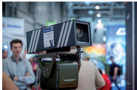
Experimentální platforma pro rychlou detekci vzdálených objektů, jako jsou například drony. Autor: Václav Koníček
