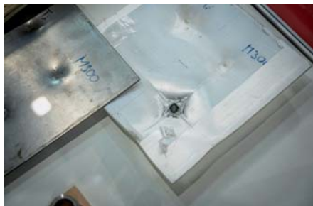
FSI VUT ukázala vzorky multivrstvé balistické ochrany, která kombinuje vlastnosti kovových a nekovových materiálů. Autor: Václav Koníček
