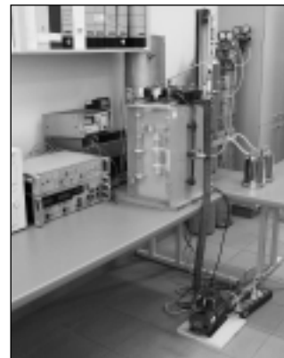
Obr. 5 Primární zařízení pro veličinu koncentrace radonu ve vzduchu, umístěné v SÚRO Praha.
