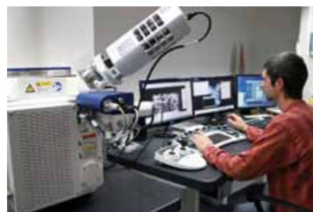
Operátor elektronového mikroskopu Pavel Kejzlar z Laboratoře analytických metod zkoumá nanovlákná modifikovaná atmosférickou plazmou, která výrazně změní vlastností povrchů
