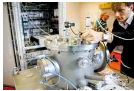
Vakuované pece – Tato nejmodernější je výjimečná v tom, že dokáže při povlakování snoubit chemický a fyzikální proces,“ uvedl Mateusz Fijalkowski
